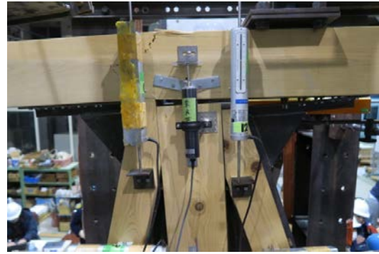
写真7 補強金物の破壊の様子
